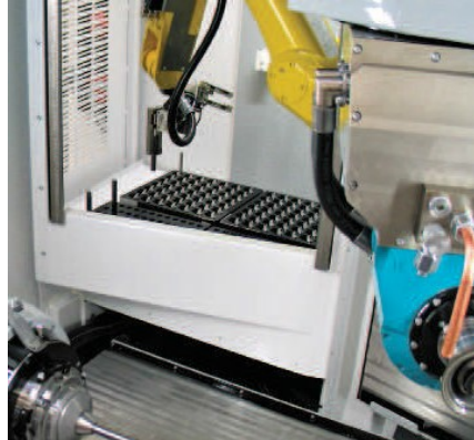
Fanuc 机器人和双卡钳系统可以管理双料盘或四料盘容量的刀具。
