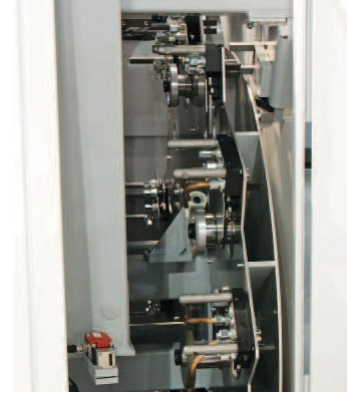
HSK50 接口的砂轮库可容纳 14 工位砂轮杆。
