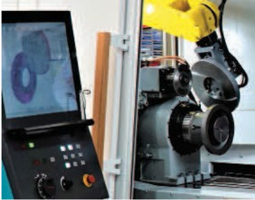
大型机器人 (最大承载 20 Kg) 实现刀具自动化上下料。
