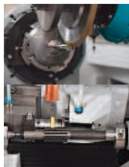
Lors du contrôle de la machine, le processus de meulage spécial «Gear Hob Profiling» (ci-dessous) ainsi que la génération et le meulage d'une fraise en carbure monobloc ont été présentés.
