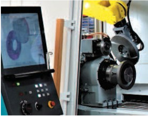
Les mandrins spéciaux peuvent être échangés avec un robot (capacité de charge 20 kg). Images: fertigung
