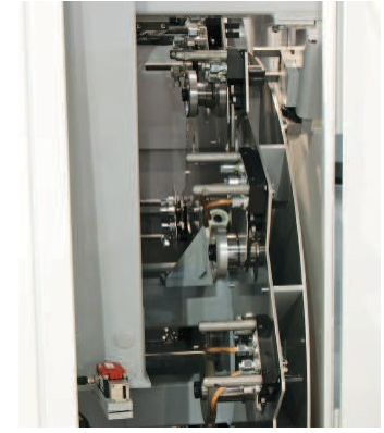
Le chargeur de meules automatique peut stocker jusqu'à 14 portes meules avec attachement HSK-50.
